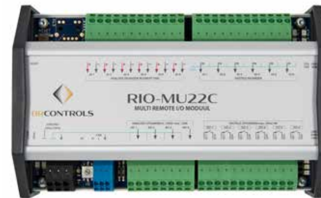
In de luchtbehandelingskasten van het distributiecentrum zijn separate regelpanelen met RIO-MU22 Multi Remote I/O modules geïntegreerd, waardoor flink op de bekabeling bespaard kon worden.
