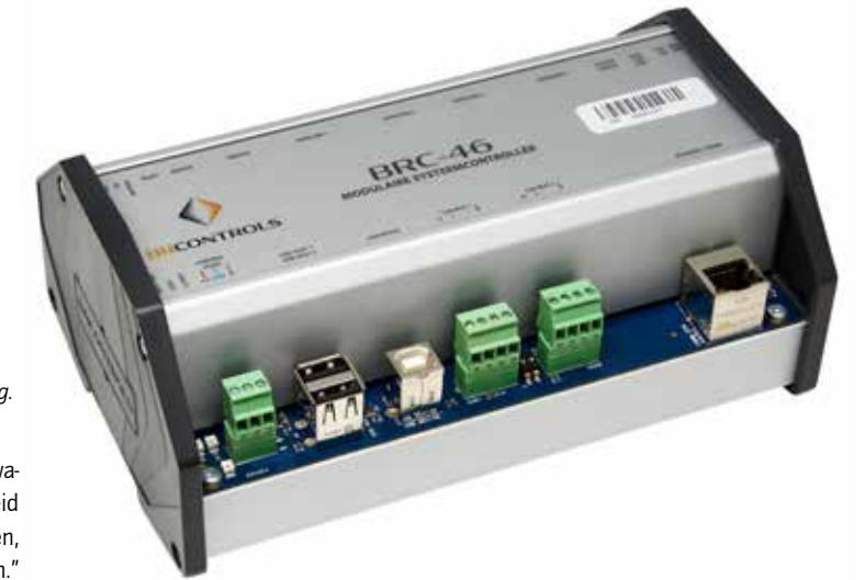
Gekozen werd voor de flexibele en vrij programmeerbare BRC-46 centrale primaire systeemcontrollers en RIO I/O modules van BRControls, waarmee het kweekwater geïntegreerd wordt beheerd en beheerst.
